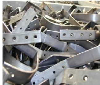
**Als Alternative für Duplexbeschichtungen: bessere Kantendeckung als bei allen Nasslacken oder zweischichtigen Duroplastpulvern.**
